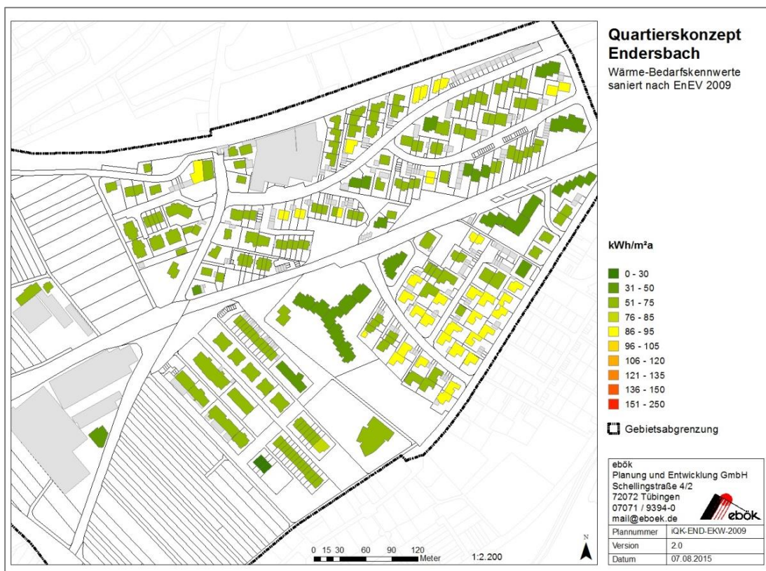
Abb. 14: Heizwärmebedarf (ohne Warmwasser) der Gebäude im sanierten Zustand nach dem Neubaustandard der EnEV 2009
