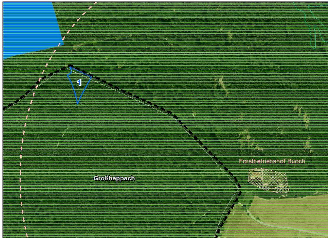
Abbildung 10: Abgrenzung der Windkraft-Potenzialfläche Nr. 1 „Roter Stich“ bei einem Siedlungsabstand von 800 m (FNP) bzw. 600 m (Außenbereichsbebauung)
