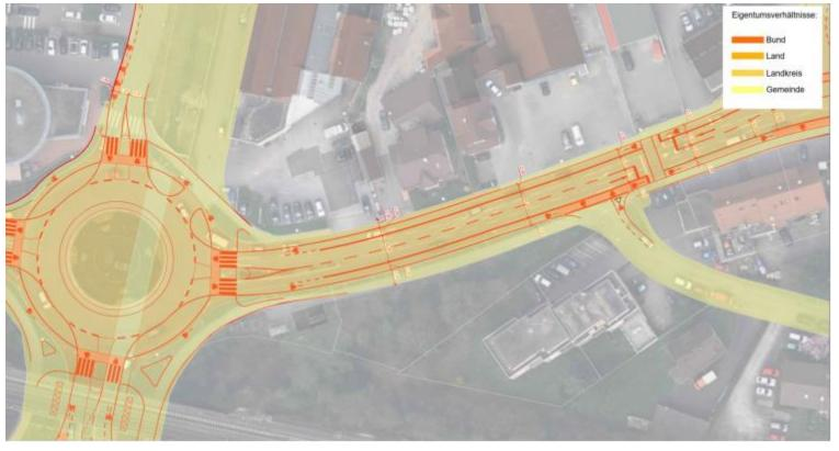
Eine Fahrbahnverengung findet in diesem Fall statt, wobei im Bestand bereits 6,60 Meter stellenweise vorliegen was eine Einengung (6,20 Meter) von 40 cm nach sich zieht.
