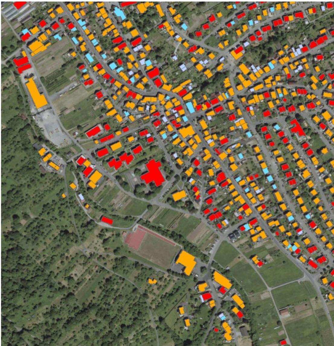
Abb. 35: Eignung von Dachflächen zur Nutzung von Solarenergie nach [LUBW 2002]
