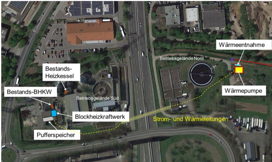
Abb. 40: Standorte Heizzentralen Kläranlage mit Verbindungsleitung (Quelle: Google Earth)
