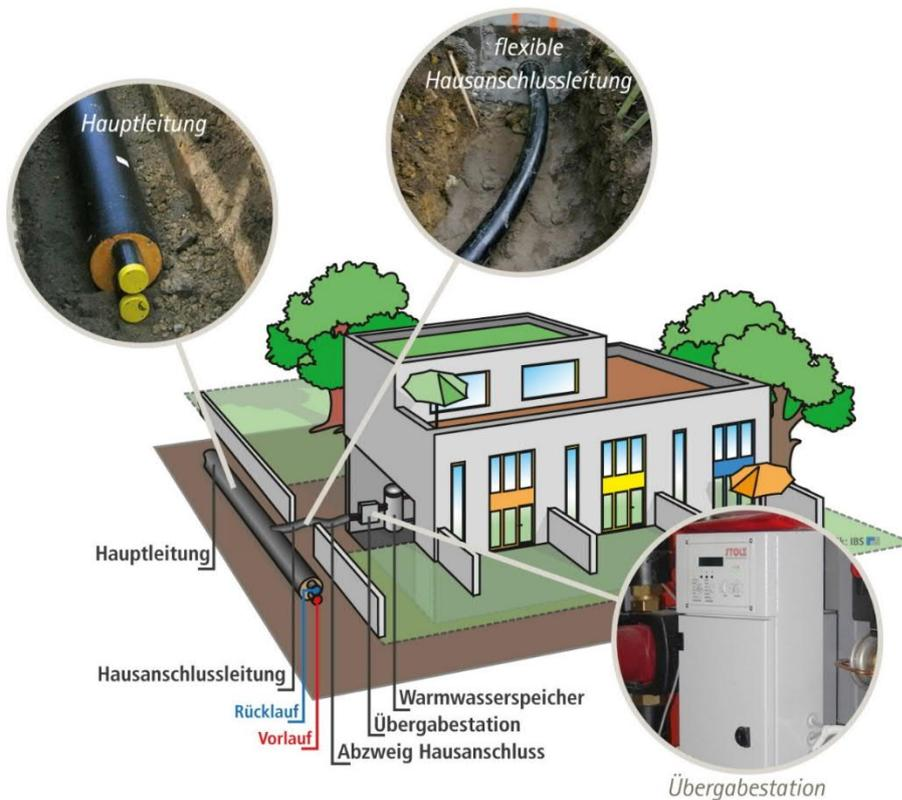
Abb. 12: Wesentliche Bestandteile Nahwärmenetz
