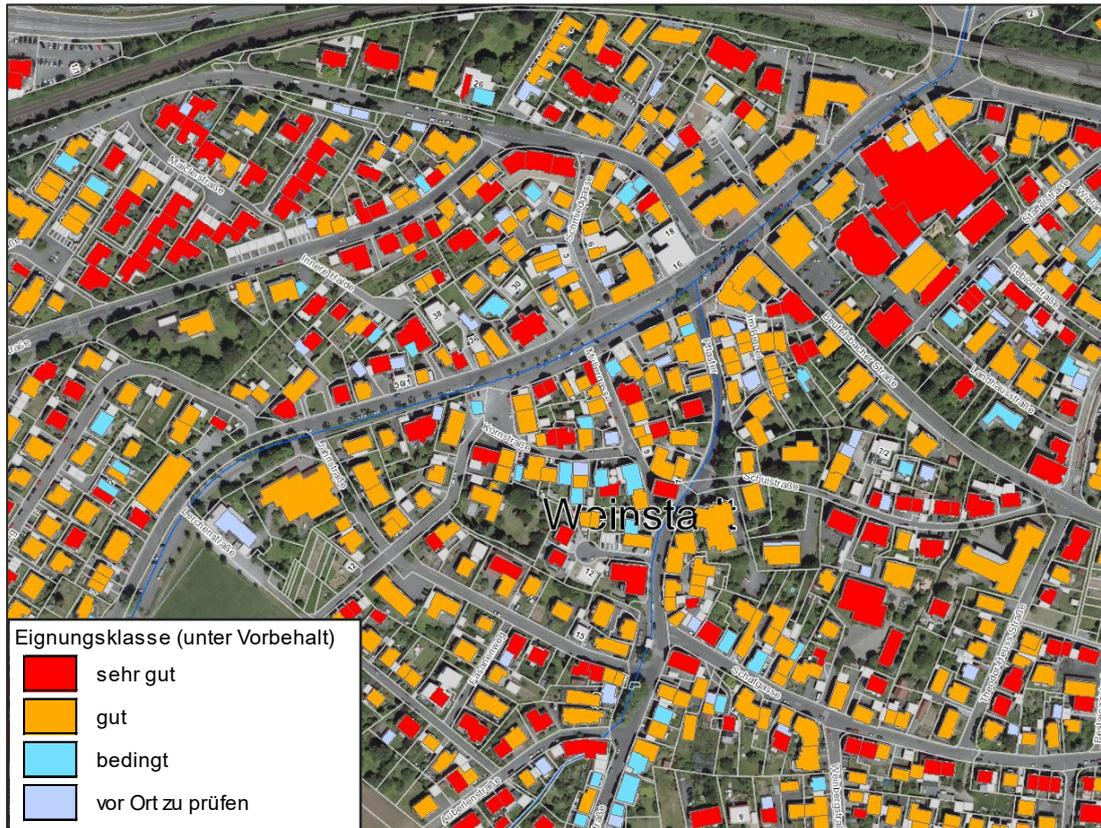
Abb. 33: Eignung von Dachflächen zur Nutzung von Solarenergie nach [LUBW 2002]
