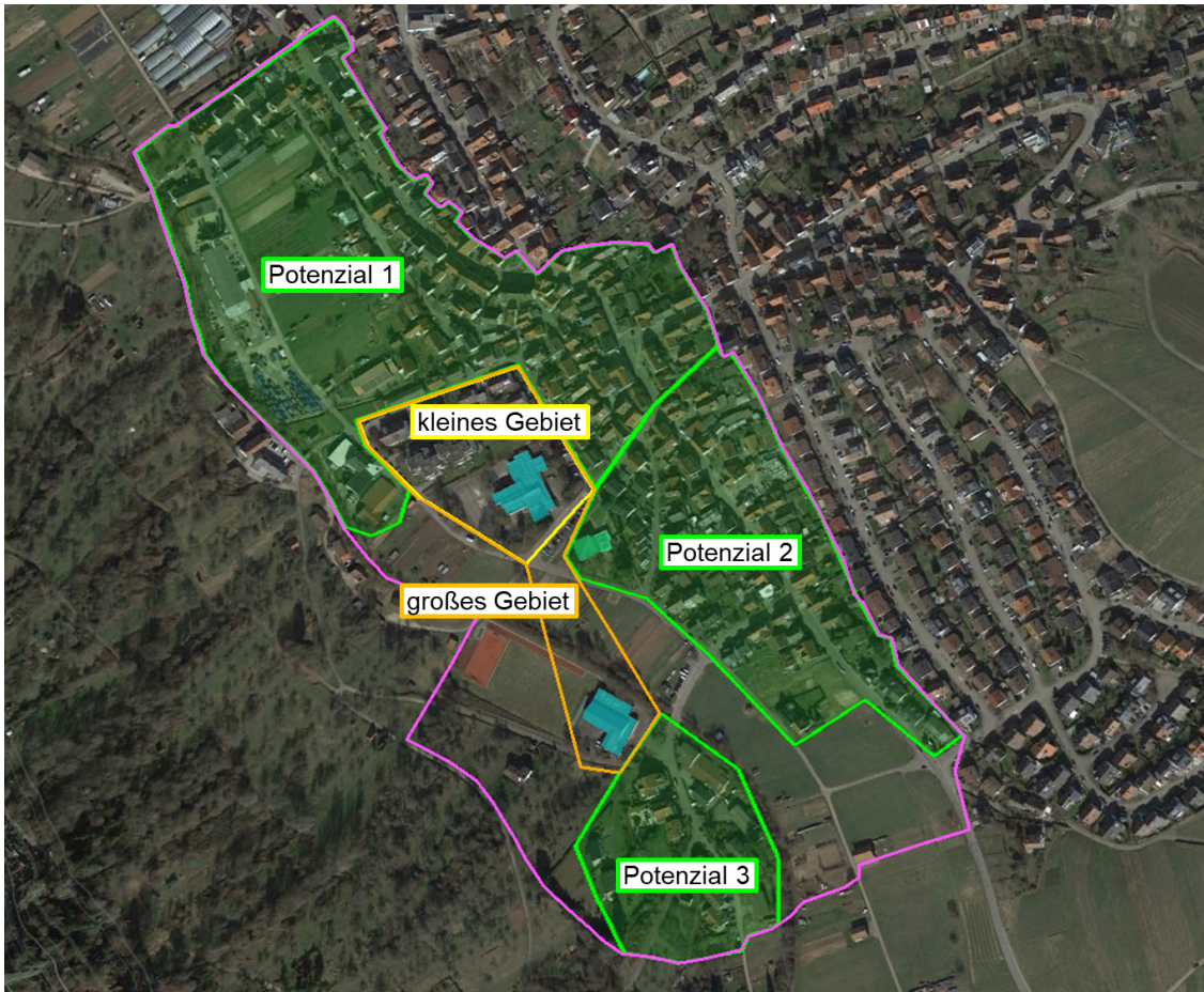
Abb. 9: Potenzialgebiete und Nahwärmeversorgungsgebiete klein/groß (Quelle: Google Earth)
