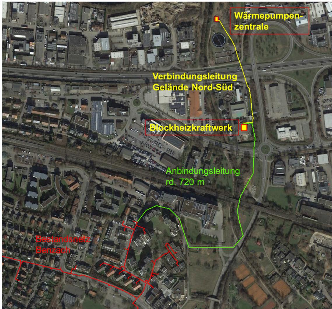
**Abb. 14:** mögliche Leitungsführung von der Kläranlage bis zum Bestandsnetz (Quelle: Google Earth)
