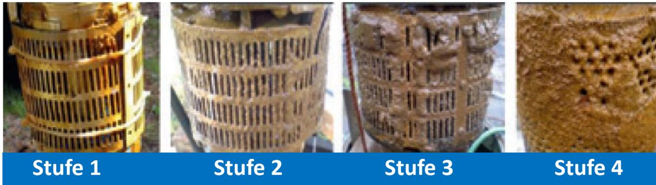
Dargestellt sind verschiedene Stufen einer Verockerung, die sowohl am Brunnenfilter des Saug- bzw. Förderbrunnens, als auch an der Förderpumpe und in der Injektionsleitung bzw. im Ausbau des Schluckbrunnens auftreten kann.
