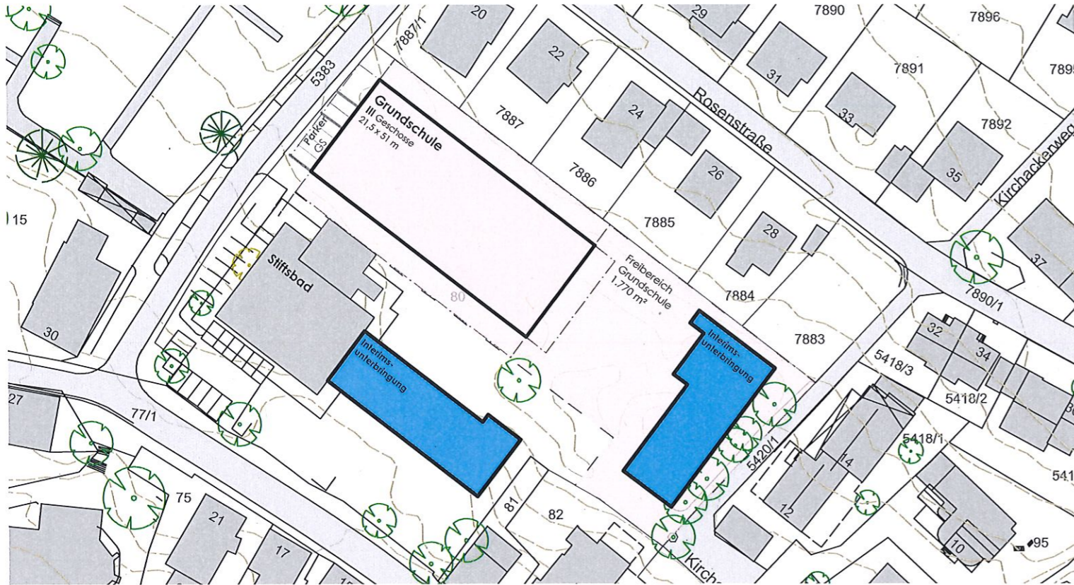
Bauabschnitt 1: Rückbau Altbau, BA 1959 und 1975, Neubau Grundschule
