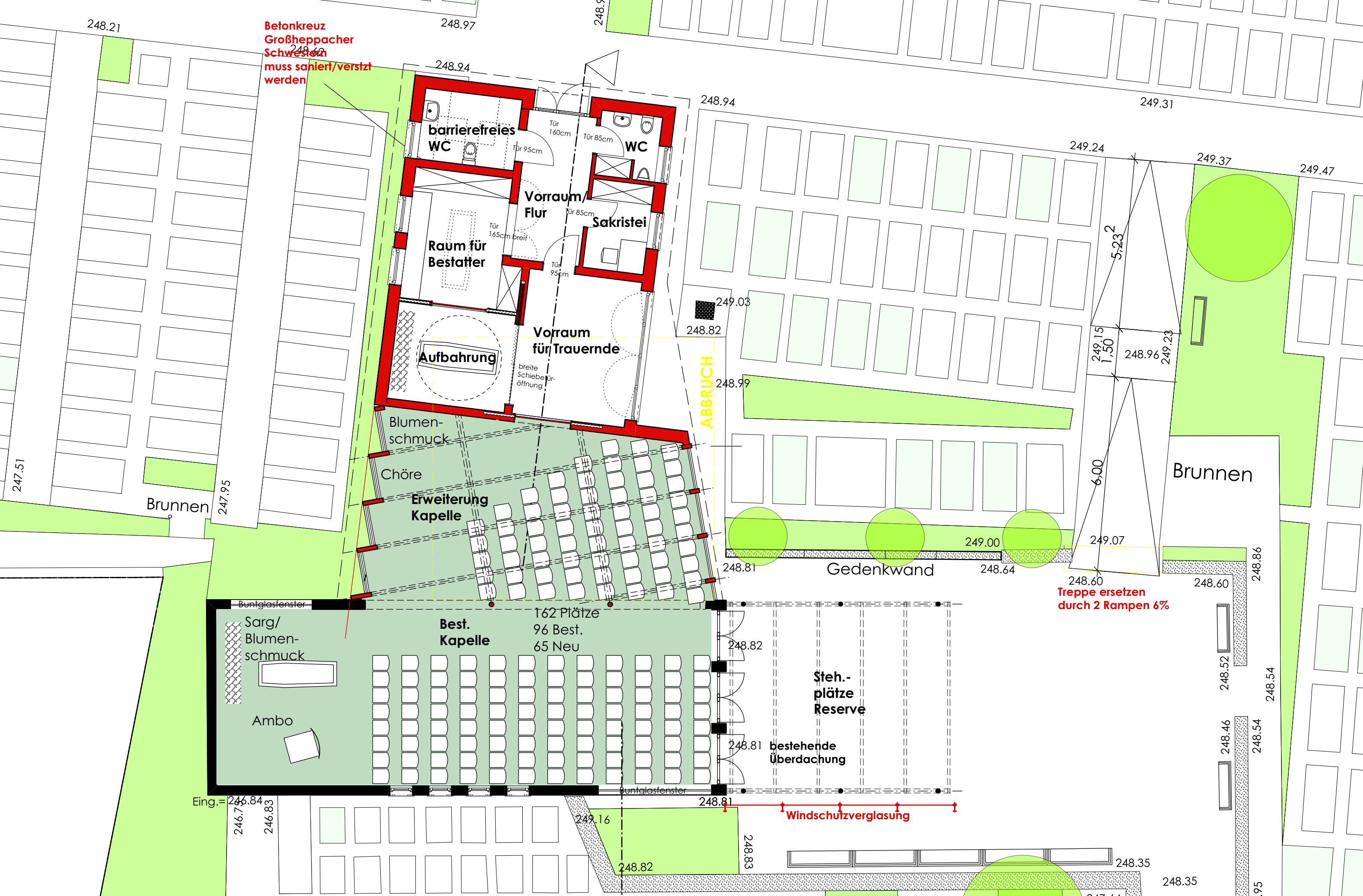
ERWEITERUNG AUSSEGNUNGSHALLE FRIEDHOF WEINSTADT-BEUTELSBACH - ENTWURF - 02/09/2019 - GRUNDRISS EG - M=1:100
