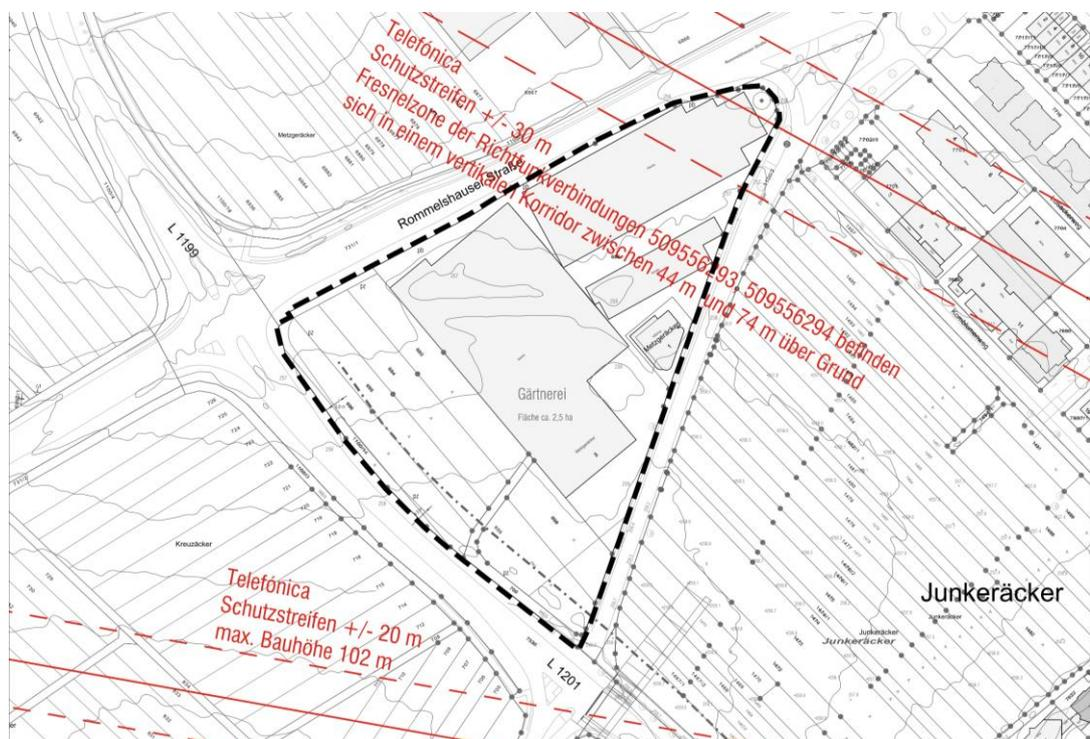
Abbildung 2: Übersicht vorhandener Richtfunktrassen mit Schutzabstand, Stand Oktober 2018
